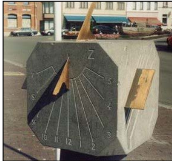
Fig. 8. Vijfvlak zonnwijzer op een (aan de hoekpunten afgeschuinde) kubus op het Mercatorplein in Rupelmonde (B).
