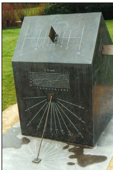
Fig. 1. De polyedrische zonnwijzer. a) links: vanuit het ZZO ziet men de polaire zonnwijzer, de verticale zuid- en oostwijzer en de horizontale zonnwijzer; b) rechts: vanuit het NW ziet men de vlakke equatoriale zonnwijzer en de verticale noord- en westwijzer.
