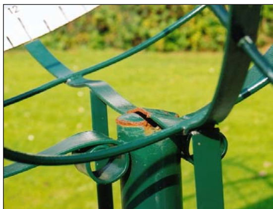
Fig. 4. De constructie van de steunen kan de krachten niet opvangen die ontstaan wanneer kinderen aan de hoepels gaan schommelen.
