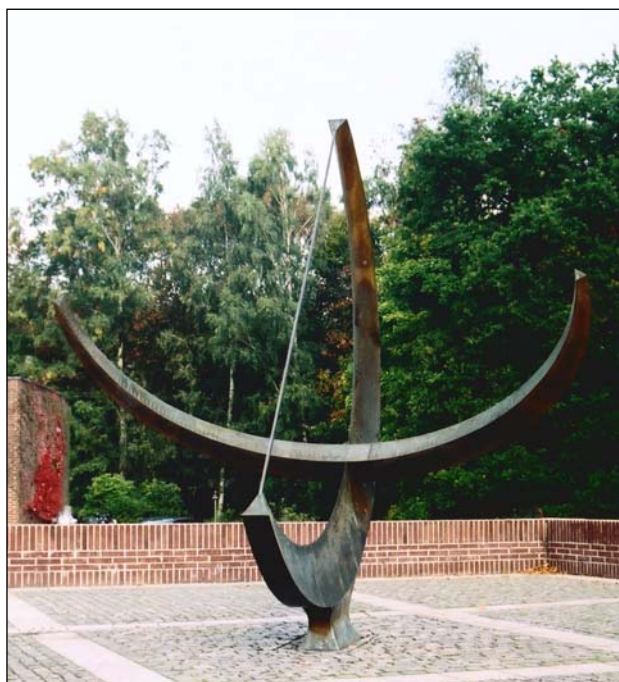
Fig. 11. De prachtige equatoriale zonnenuur van Henri Moore bij het voormalige opleidingscentrum van IBM in La Hulpe. De diameter is 3,6 meter; de schaal loopt van 6 tot 6 (18) uur, onderverdeeld per 5 minuten. De poolstijl is 24 mm dik, toereikend voor een duidelijke schaduw op de urenband.
