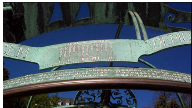
Fig. 9.a. De monumentale armillairsfeer van Lothar Loske in Frankfurt na de herplaatsing. De ring even onder het midden is draaibaar en draagt ruim 200 plaatsnamen. b. Een deel van de wereldtijdschaal. De tijdsvereffening wordt ingesteld langs de maandschaal in het midden. Daarboven de dubbele boog voor de precieze bepaling van het lokale middaguur. Foto's: Reinhold Kriegler.
