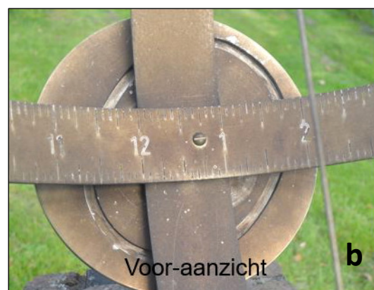
Fig. 2. a. Algemene impressie van de armillaarsfeer; b. de datumschijf met de tijdsvereffeningsgroef.
