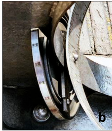
Fig. 12. a . Algemene impressie van de Vlissingse armillairsfeer; b . de schijf met de tijdsvereffeningsgroef.
