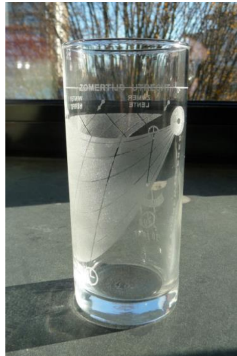
Fig. 9. Een zonnwijzerglas van Hendrik Hollander was het lustrumgeschenk 2008 voor de leden. Het glas is licht conisch en Hendriks programma hield daar rekening mee. Het zonnwijzerpatroon, voor zomertijd in Utrecht, is aangebracht door lasergrovering.
