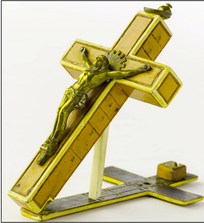
Het crucifix (inv.nr. 467) heeft zes polaire zonnwijzertjes op de zijkanten. Met het steuntje wordt de breedte ingesteld; het blokje op het voetstuk bevat een kompasje. (Foto: © Province de Liège - Musée de la Vie wallonne)
