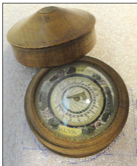
In dit magnetische zakzonnwijzertje (inv.nr. 332) zijn het papieren wijzerplaatje en de poolstijl samen op de kompasnaald bevestigd. (Foto: Jan ten Böhmer)
